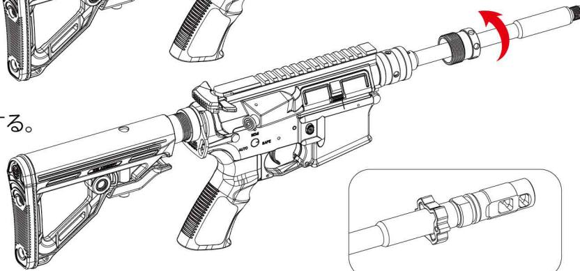
**3 依序組裝護木定位環及防火帽, 並鎖緊定位螺絲**
